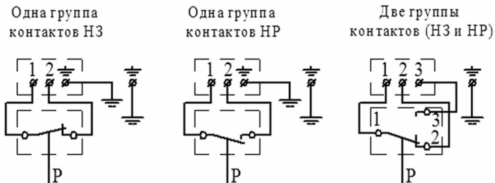
Рисунок 3. Схема электрическая соединений реле давления РК-301Д
